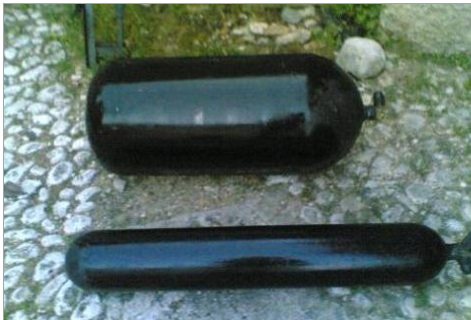
Serbatoi di metano compresso
